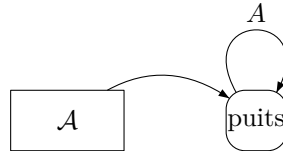
FIGURE 1.21 – Complétion par ajout d'un état puits
